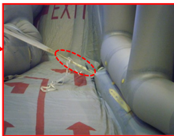
ストラップが解けずに引っかかっている状態
