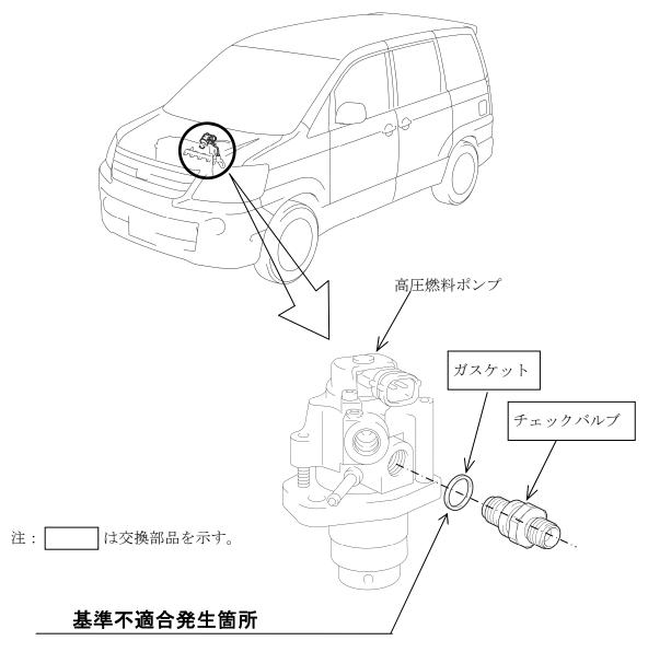
エンジンの高圧燃料ポンプにおいて、チェックバルブ(逆止弁)締結部ガスケットのばらつきによるシール性評価が不足していたため、長期間使用するとガスケットの応力緩和によりチェックバルブ締結力が低下するものがある。そのため、そのまま使用を続けると、締結ねじ部を伝って燃料が漏れるおそれがある。
