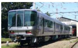
蓄電池を活用した 鉄道車両
