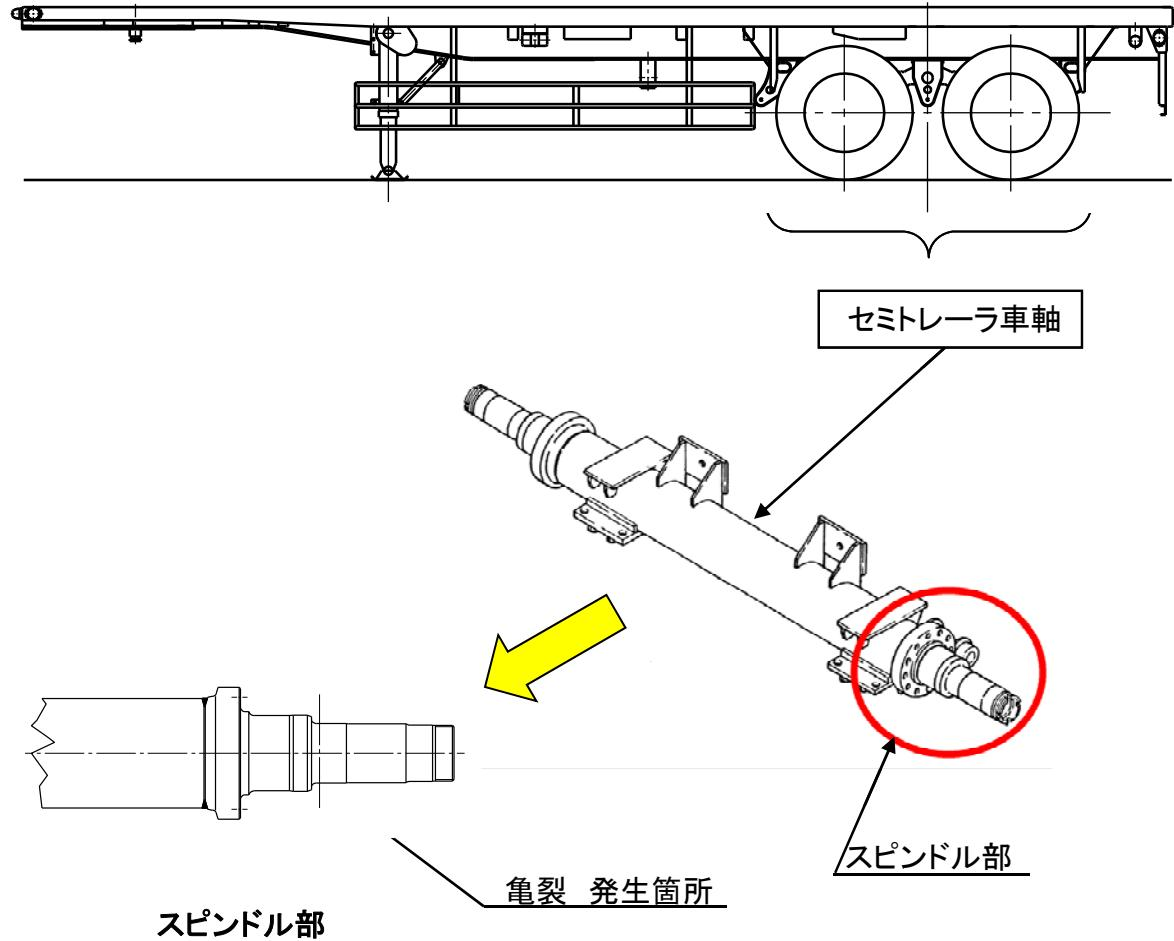
セミトレーラ及びポールトレーラに使用している車軸において、使用環境に対する強度の余裕が少ないため、長期の使用によりスピンドル部に亀裂が発生する場合がある。そのため、そのままの状態で使用を続けると、最悪の場合、車軸が折損するおそれがある。
