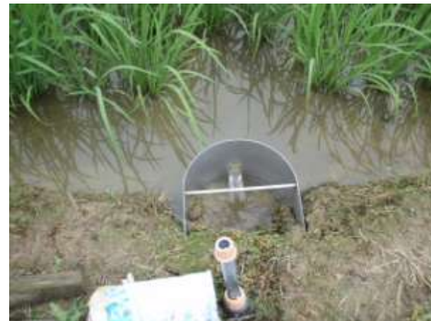
排水口の装置
