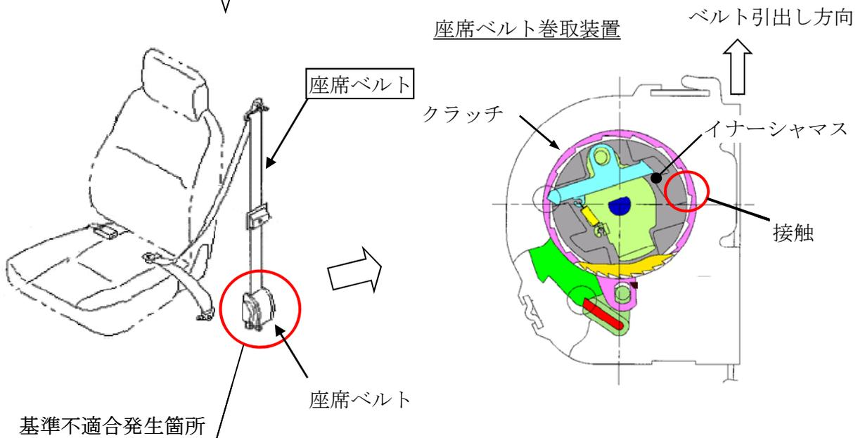
座席ベルト巻取装置の内部部品（イナージャマス）の製造工程において、不適切な材料を使用したため、当該部品が変形し、座席ベルトが引き出せなくなるおそれがある。
