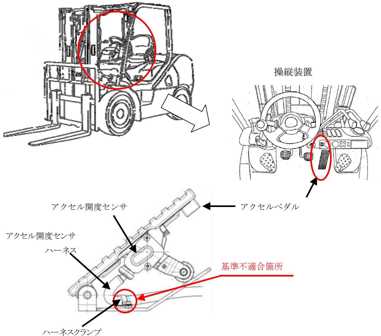
アクセルペダルに備えられているアクセル開度センサにおいて、ハーネスクランプの締付けトルクが不足しているものがあるため、そのままの状態で使用を続けると当該クランプが外れ、アクセル開度センサハーネスとアクセルペダルが干渉するおそれがある。
