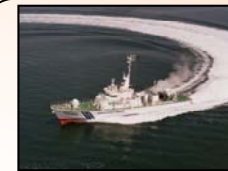
高速性能・運動性能の向上 (ウォータージェット推進)
