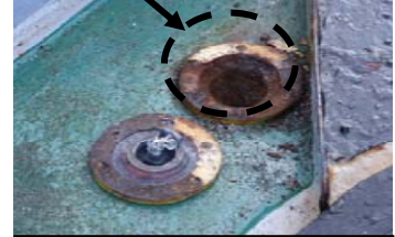
バラストタンク測深管腐食
