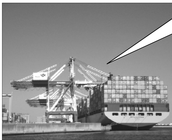
【大型で荷役効率が高いガントリークレーン】
