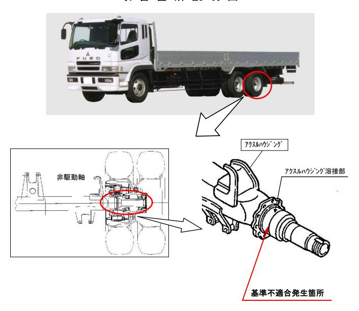
後2軸大型トラックの後々軸(非駆動軸)アクスルハウジングの溶接が不適切なため、当該溶接部に 亀裂が発生するものがある。そのため、そのままの状態で使用を続けると、最悪の場合、当該アクスル ハウジングが折損し、ブレーキの過熱やタイヤとフレームの接触が生じて、火災に至るおそれがある。
