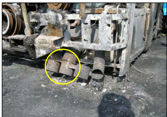
写真 23 マフラー出口 左の 2 本がマフラー 右の 1 本はプレ・ヒータ配管
