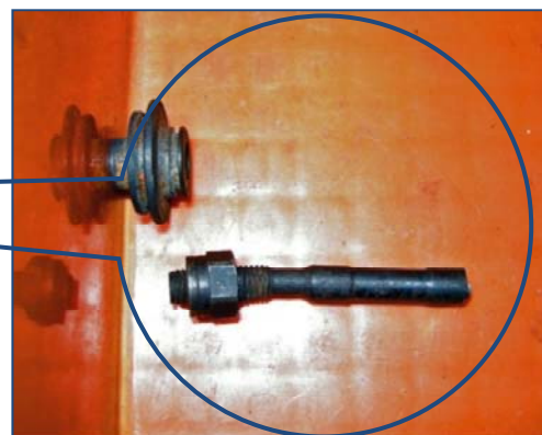
写真 17 右ターボチャージャー シャフトとスラストスリーブ
