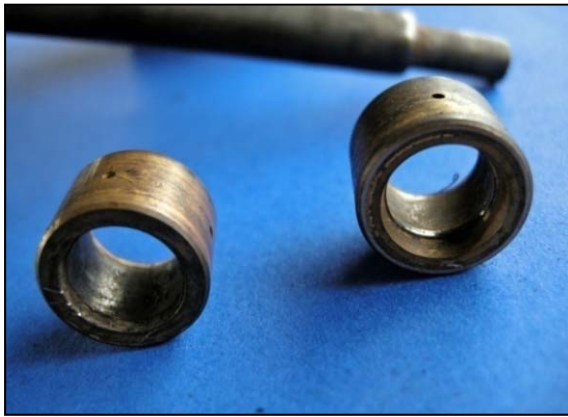
写真 20 フローティングメタル 内面が摩耗
