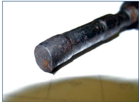
写真 21 シャフト折損部
