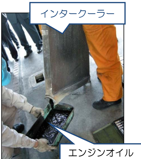
写真10 インタークーラー エンジンオイルと水が混入
