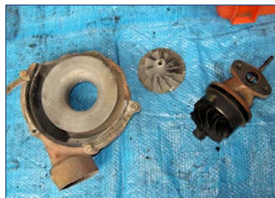
写真 19 左ターボチャージャー ハウジングは熱により変形
