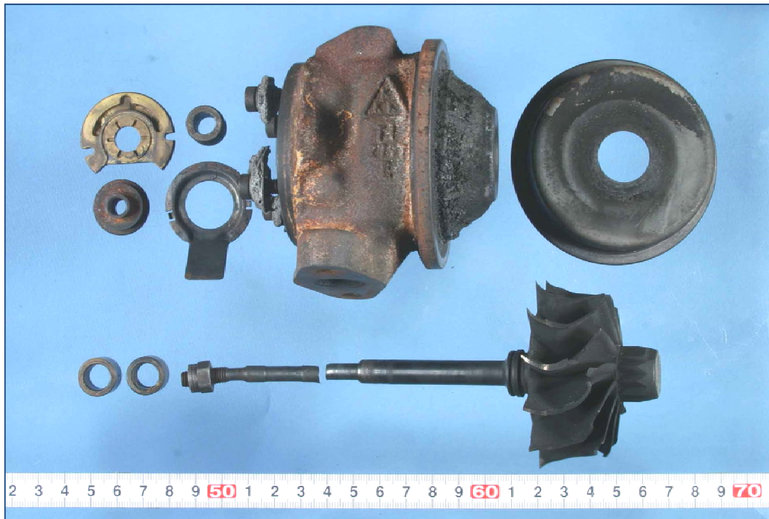
写真 25 右ターボチャージャー構成部品 (残存部品)
