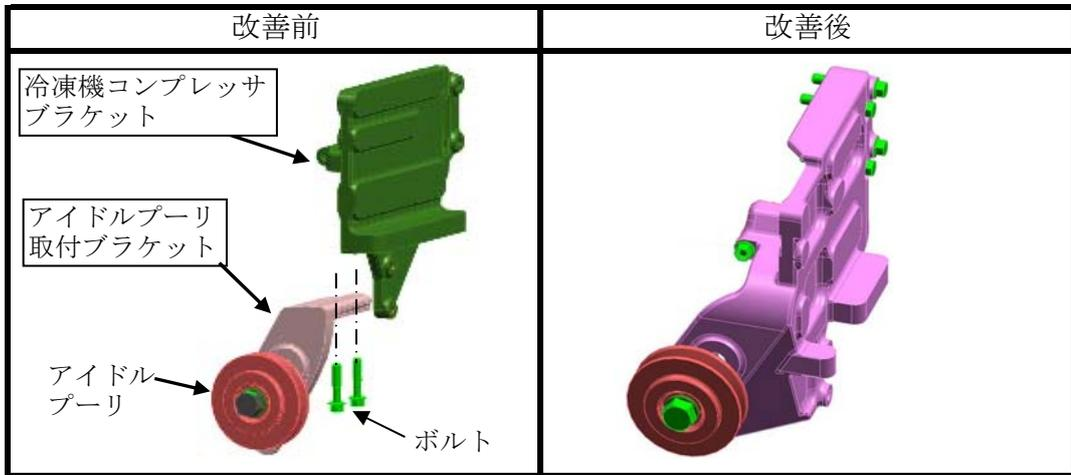
冷凍車架装を行う車両の原動機において、冷凍機コンプレッサ駆動ベルト用のアイドルプーリ取付ブラケットの取付強度が不十分なため、ベルト張力及びコンプレッサ駆動力等により、当該ブラケットと冷凍機コンプレッサブラケットの合わせ面が摩耗するものがある。そのため、そのままの状態で使用を続けると、当該ブラケット取付ボルトが折損し、最悪の場合、プーリ及びブラケットが脱落し、他の交通の妨げとなるおそれがある。
