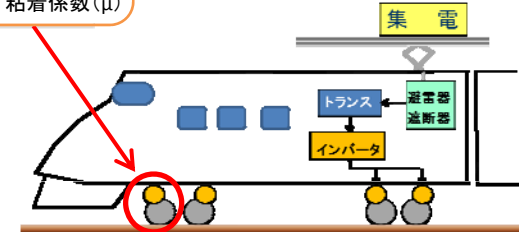
レールと車輪との間の摩擦力により駆動
