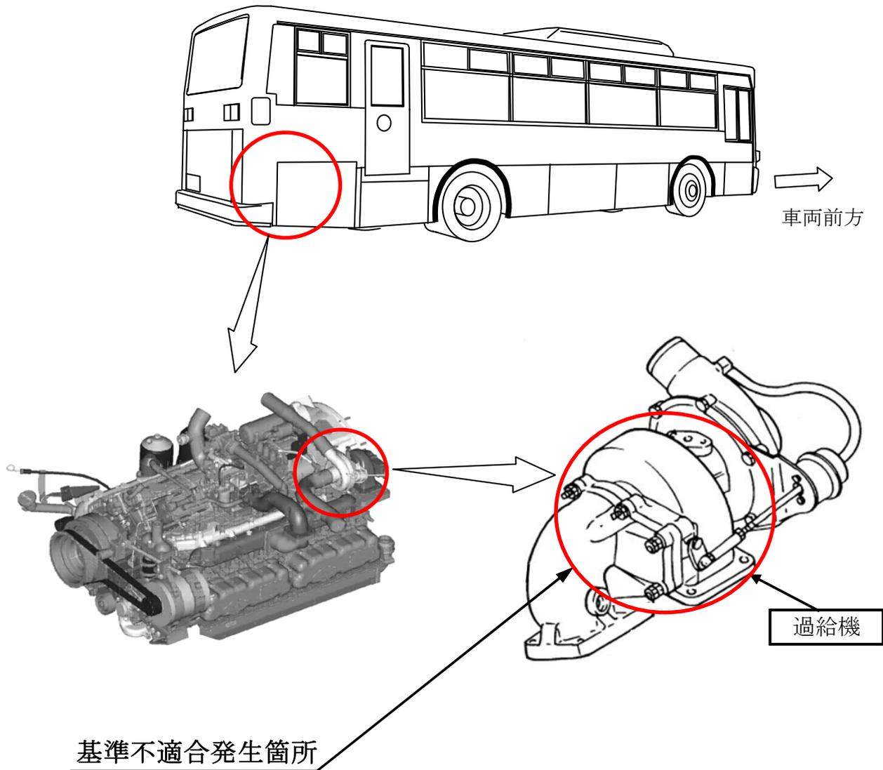
圧縮天然ガス自動車の過給機において、タービン翼の強度が不足しているため破損するものがある。そのため、白煙の発生及び出力不足になり、運行できなくなるおそれがある。
