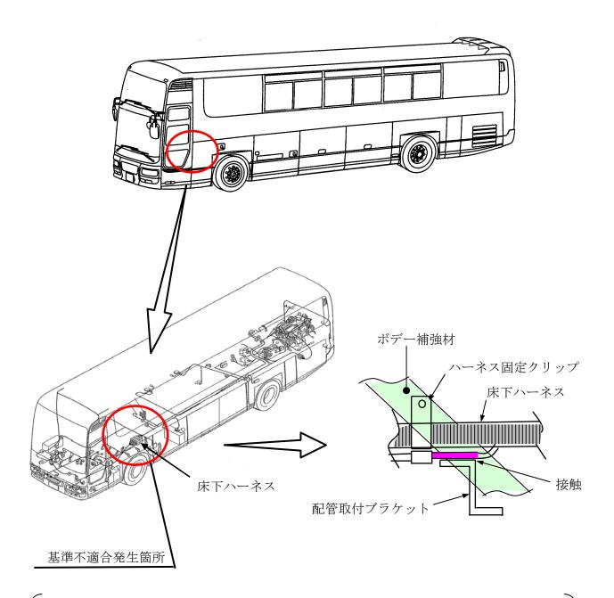
大型バスにおいて、床下ハーネスの配索が不適切なため、ハーネスが配管取付ブラケットと接触しているものがある。そのため、そのままの状態で使用を続けると、車両振動等により被覆が損傷し、最悪の場合、エンジンストール及び灯火器等が不灯に至るおそれがある。
