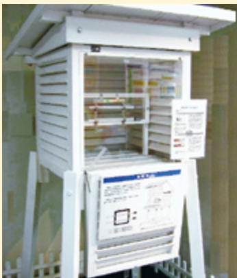
百葉箱(昔懐かしい?) かつては自然通風式の百葉箱を使用していました。
