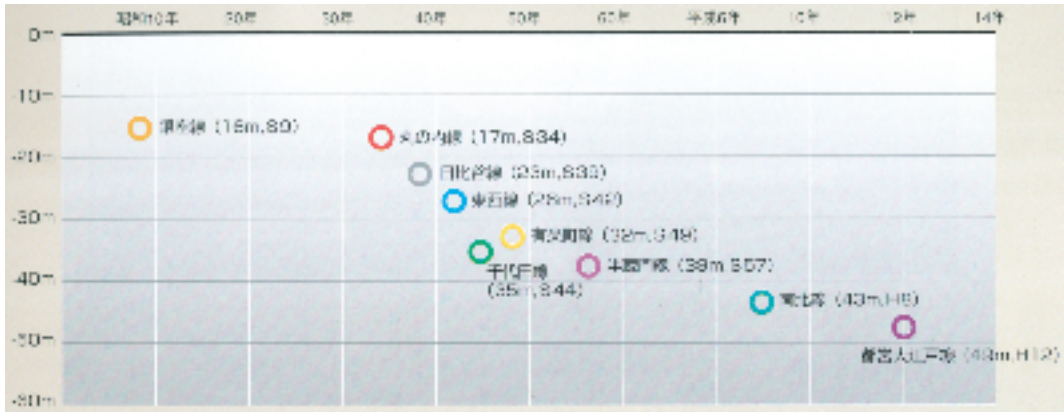
図 1-2 東京における地下鉄深度の変遷
