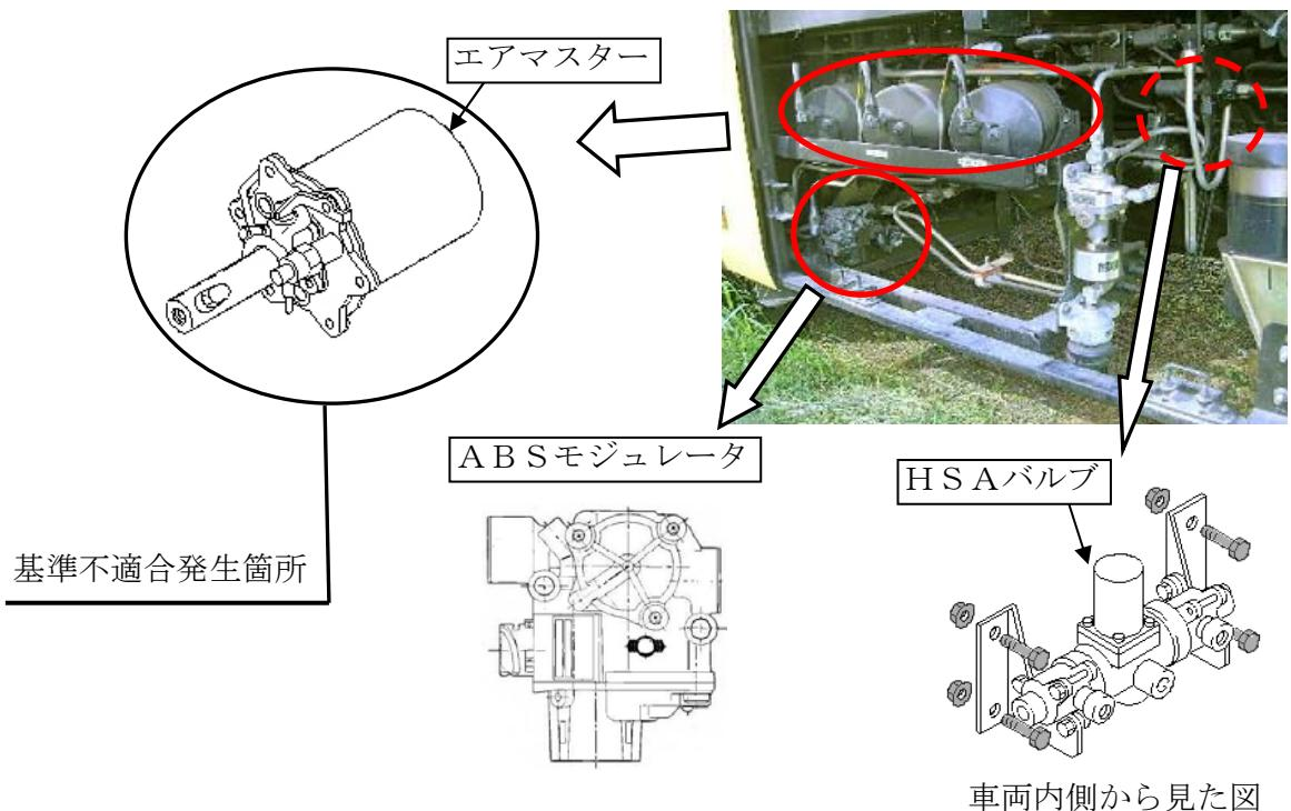
バスの制動装置において、ブレーキ配管の洗浄が不適切なため、ブレーキ液に混入した異物により、倍力装置（エアマスター）からブレーキ液が漏れことがある。そのため、そのままの状態で使用を続けると、坂道発進補助装置（HSA：ヒル・スタート・エイド）及びABSモジュレータのゴム部品が侵され、最悪の場合、ブレーキが解除できなくなるおそれがある。
