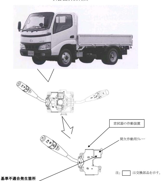
窓拭器の作動装置に内蔵されている間欠作動用リレー回路が不適切なため、間欠作動を繰り返した場合に、接点が過度に摩耗して、摩耗粉がリレー下部に堆積したり接点が脱落することがある。そのため、湿気を含んだ摩耗粉によるトラッキング、または、脱落した接点が接点間で短絡して、窓拭器の作動が不能になり、最悪の場合、窓拭器の作動装置が発火するおそれがある。
