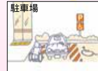
駐車場 駐車スペースは車いすを使用する方でも楽に利用できるように
