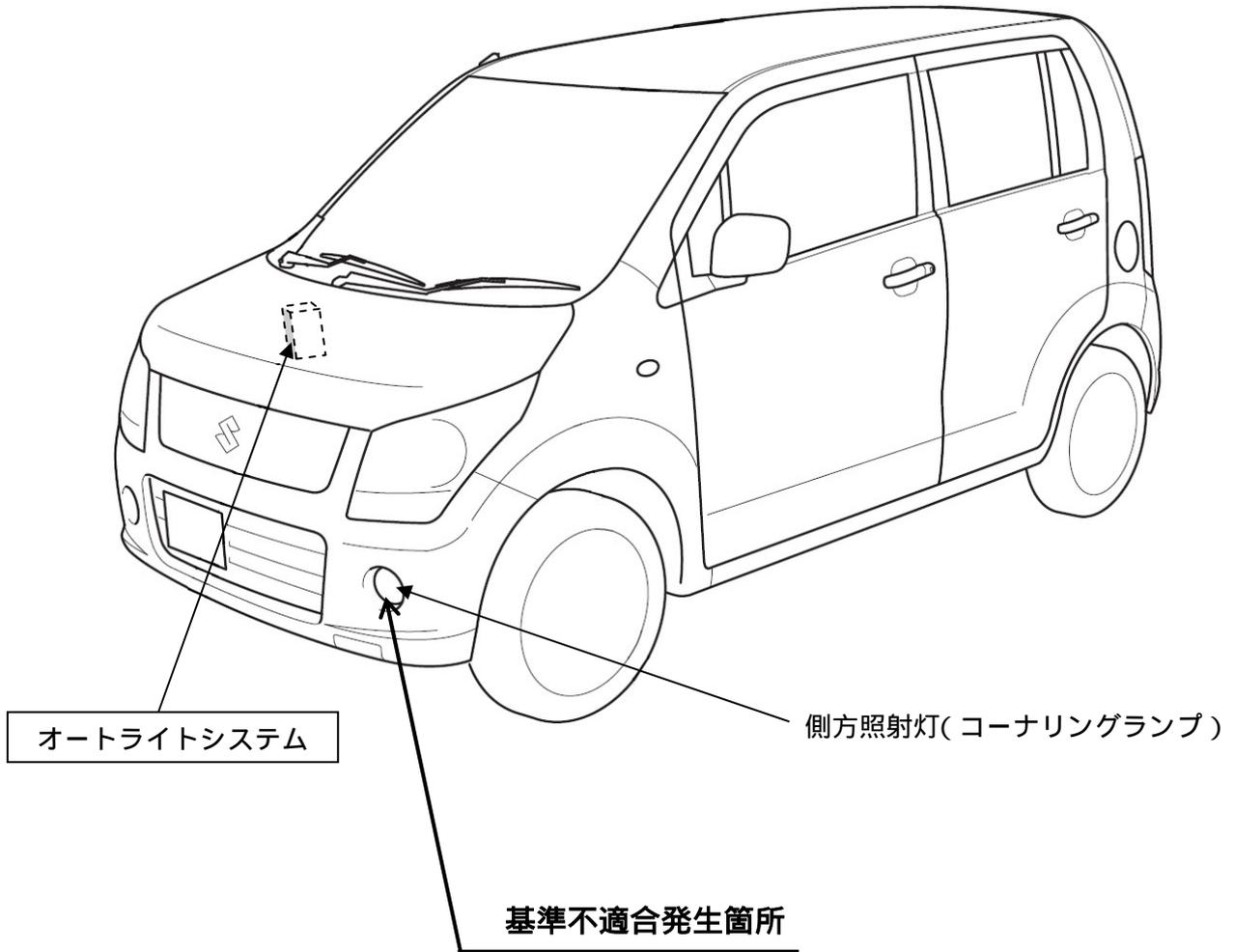
側方照射灯付車において、オプション品として設定したオートライトシステム（車外の明るさに応じて前照灯を自動的に点灯、消灯する装置）の電気回路が不適切なため、前照灯が点灯していない場合に側方照射灯が点灯し、道路運送車両の保安基準に適合しない。
