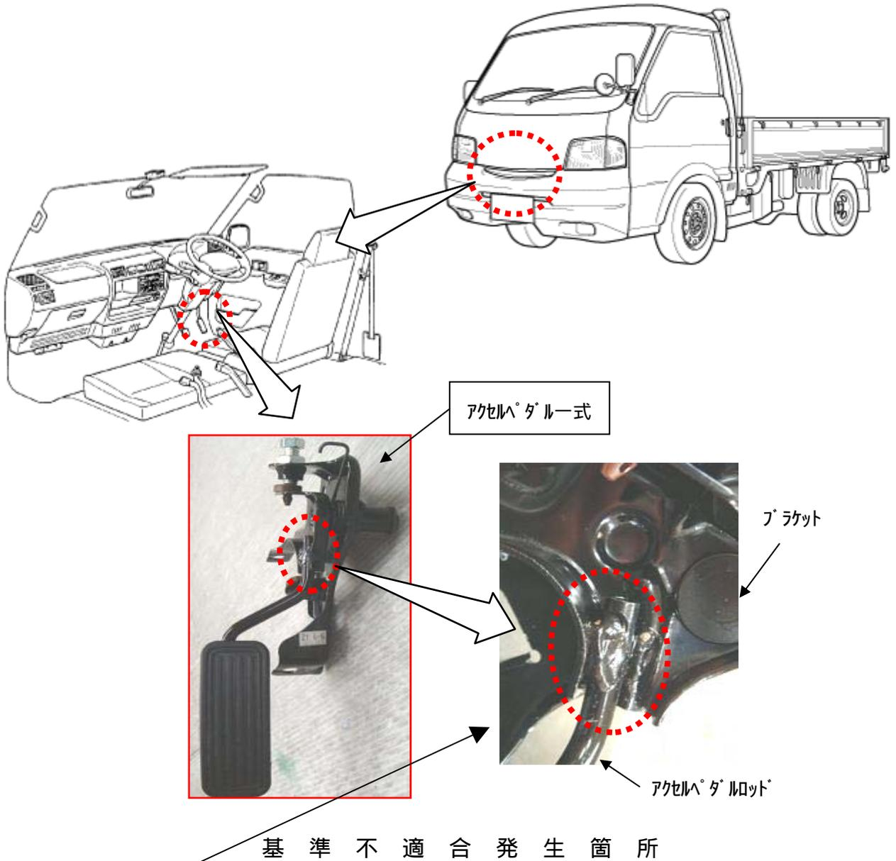
アクセルペダルの製造工程において、アクセルペダルロッドとブラケットとの溶接が不十分なものがある。そのため、そのまま使用を続けると溶接が剥がれてアクセルペダルが外れ、走行できなくなるおそれがある。
