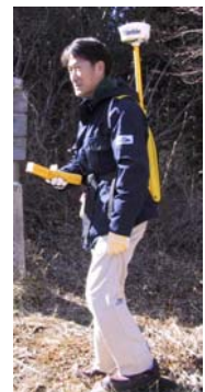
(図 10) DGPSによる測量
