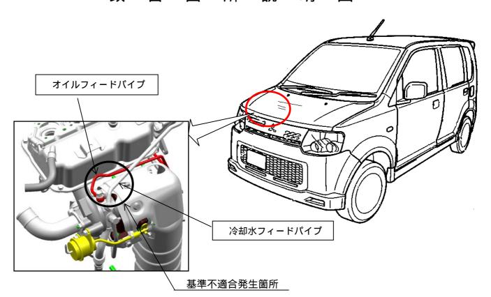
ターボチャージャ付車両において、ターボチャージャへオイルを供給するオイルフィードパイプの配管位置及び防錆処置が不適切なため、融雪剤散布地域での走行等により塩水がかかり当該パイプが腐食することがある。そのため、そのまま使用を続けると、腐食が進行して穴があき、オイルが漏れ排気管に付着し白煙が発生し、最悪の場合、漏れたオイルが発火し、火災に至るおそれがある。
