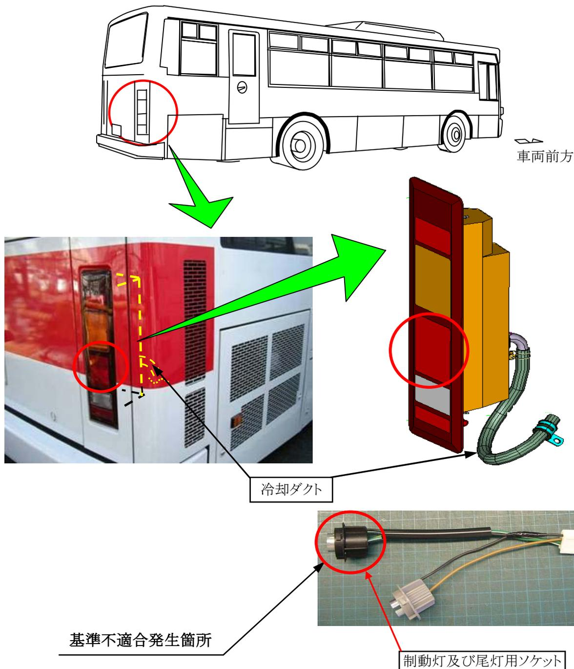
制動灯及び尾灯のソケットアース端子の構造が不適切なため、ソケット部の温度が高くなり、ソケットが変形するものがある。そのため、そのままの状態で使用を続けると導通不良となり、当該灯火器が点灯しなくなるおそれがある。
