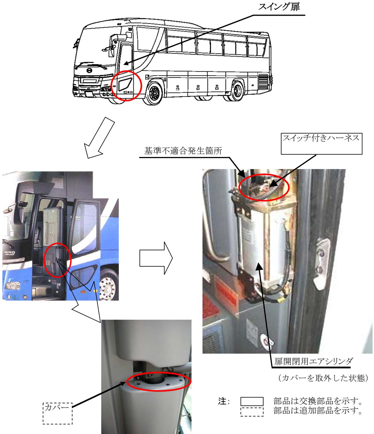
大型観光バスのスイング扉挟み込み防止機構用スイッチの防水性が不適切及び扉ロック位置を検出するスイッチ上部のカバー形状が不適切なため、その両スイッチが故障した場合に、扉の挟み込み防止機構が作動する場合があります。そのため、最悪の場合、走行中に扉が開くおそれがある。
