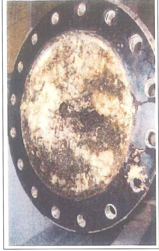
脱離液移送管のMAPによる閉塞
