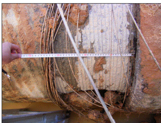
P C鋼線が発錆・破断し、管体が破裂
