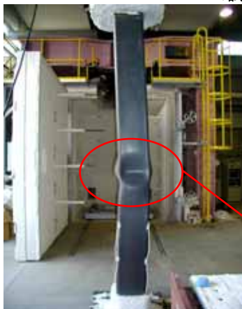
試験終了後の試験体の状況 (局部座屈が生じ不合格となった例)
