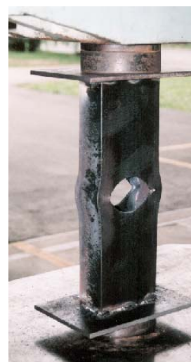
図2 エネルギー吸収構造の静荷重試験結果(φ110mm丸穴)
