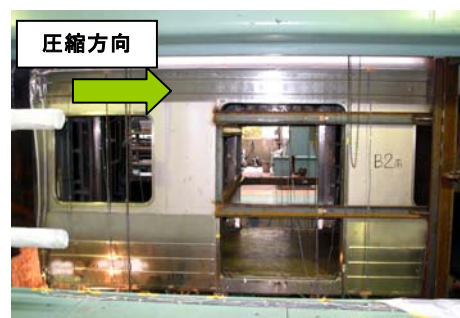
図2 圧縮試験の状況
