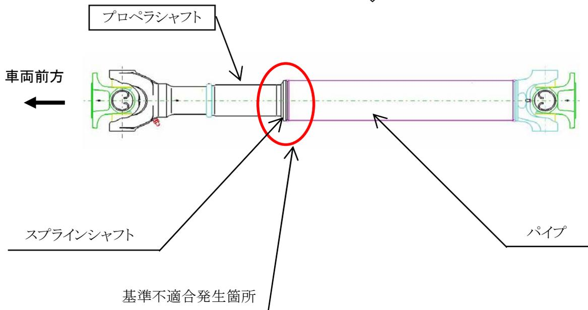
プロペラシャフトの製造工程が不適切なため、パイプとスプラインシャフトの溶接部に亀裂が発生しているものがある。そのため、そのまま使用を続けると、当該溶接部の亀裂が進展し、最悪の場合、プロペラシャフトが折損・脱落し、走行不能となるおそれがある。
