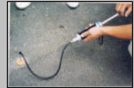
ガス検知管による表層調査
