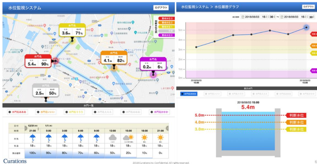
益田市 水路氾濫予知システム新管理画面
