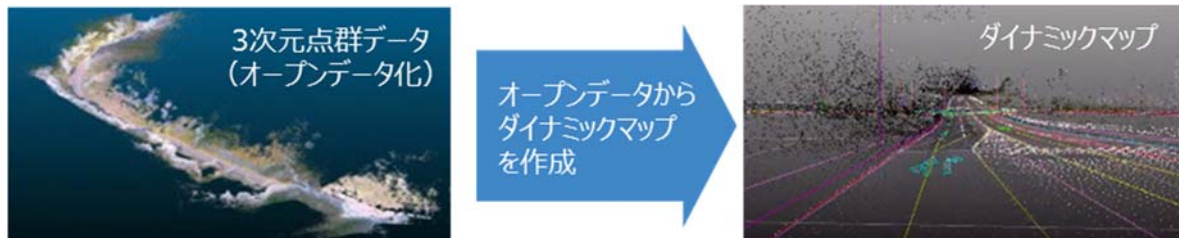
図 2-6 3次元点群データからダイナミックマップを作成するイメージ
