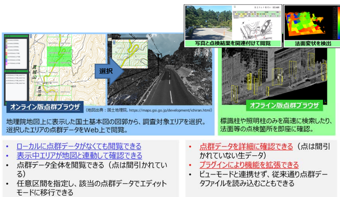
図 5-7 3次元点群データの可視化技術（点群ブラウザ 3D Point Studio）
