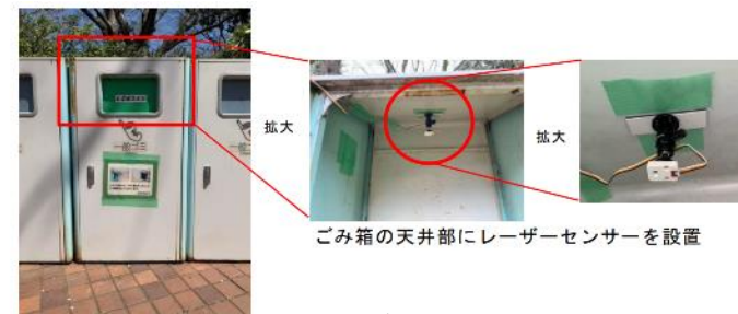
モニタリングするごみ箱と設置したセンサー
