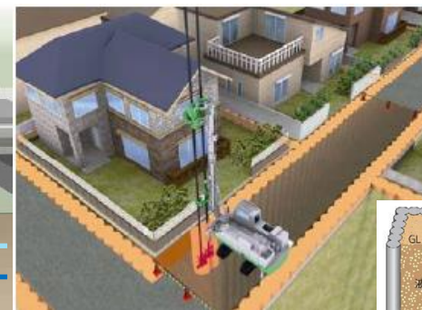
格子状中壁工法
