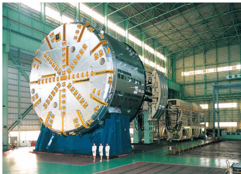
写真 7-2 飛驒トンネル本坑TBM（φ12.84m）
