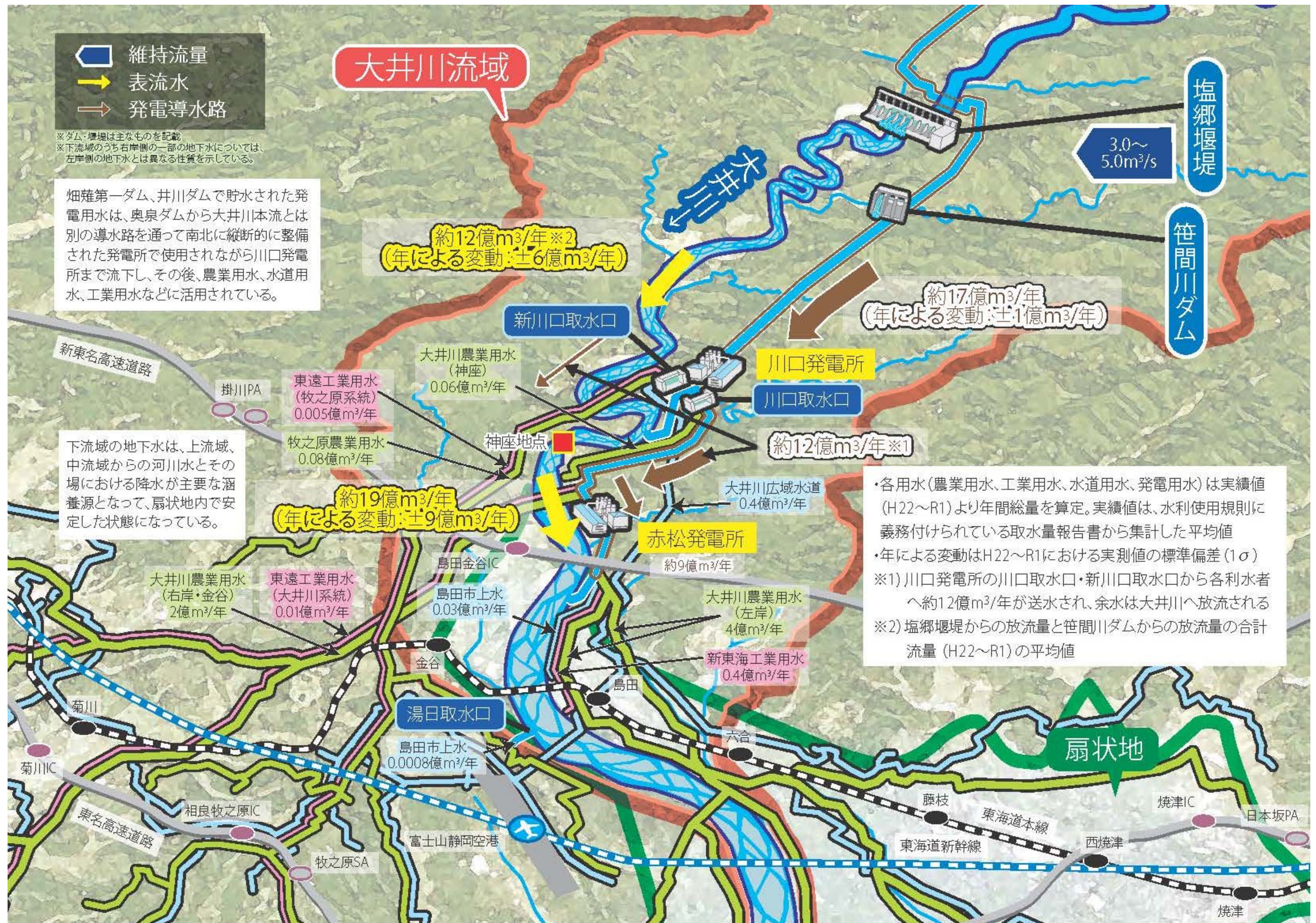
図 2.35 大井川流域の水循環の概念図 <下流利水者取水口付近拡大図>
