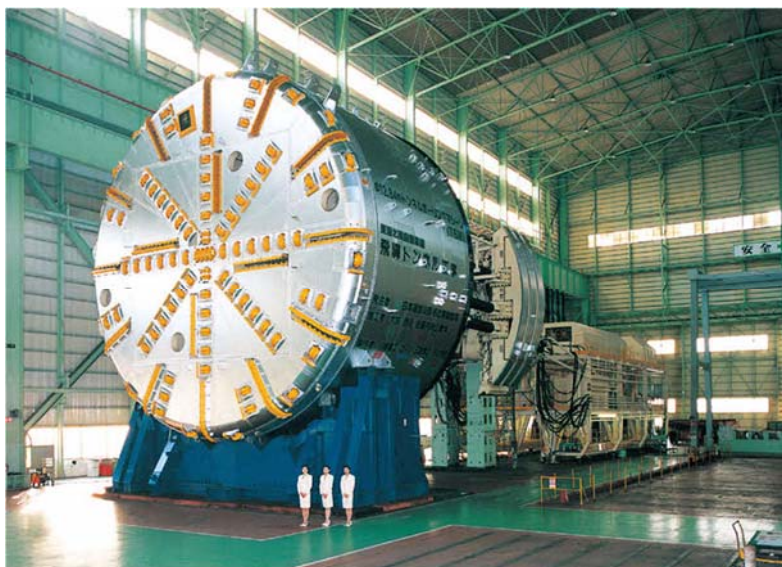
写真 7-2 飛驒トンネル本坑TBM（ \phi 12.84\text{m} ）
