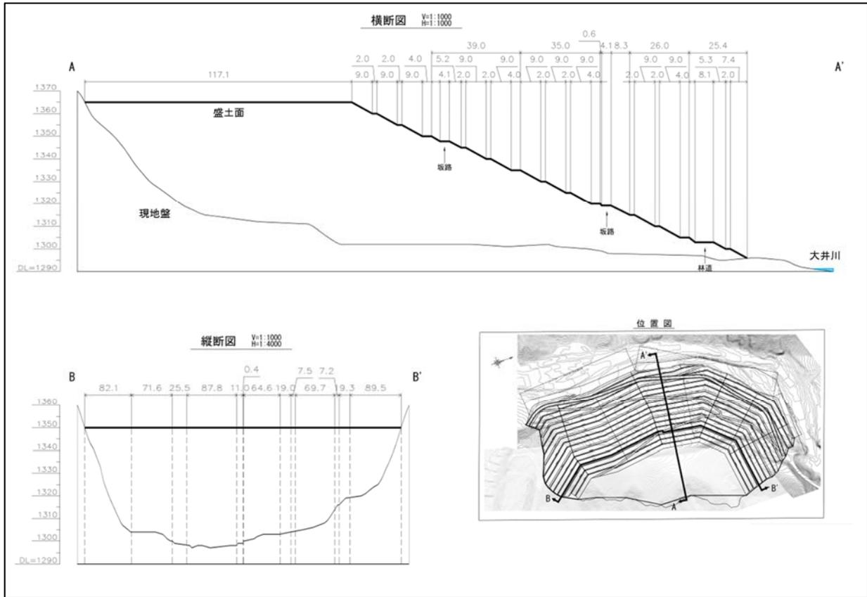
図 6-9 燕沢付近発生土置き場 縦横断面図
