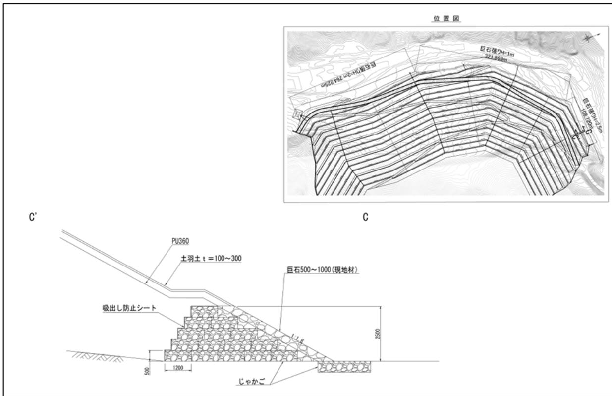
図 6-11 盛土のり尻巨石積み詳細図
