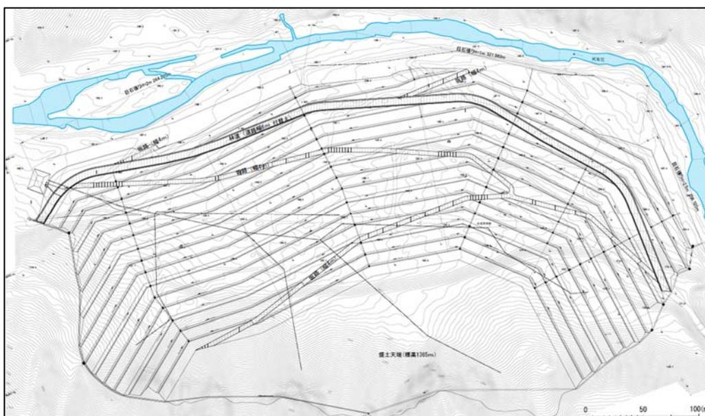
図 6-8 燕沢付近発生土置き場 計画平面図
