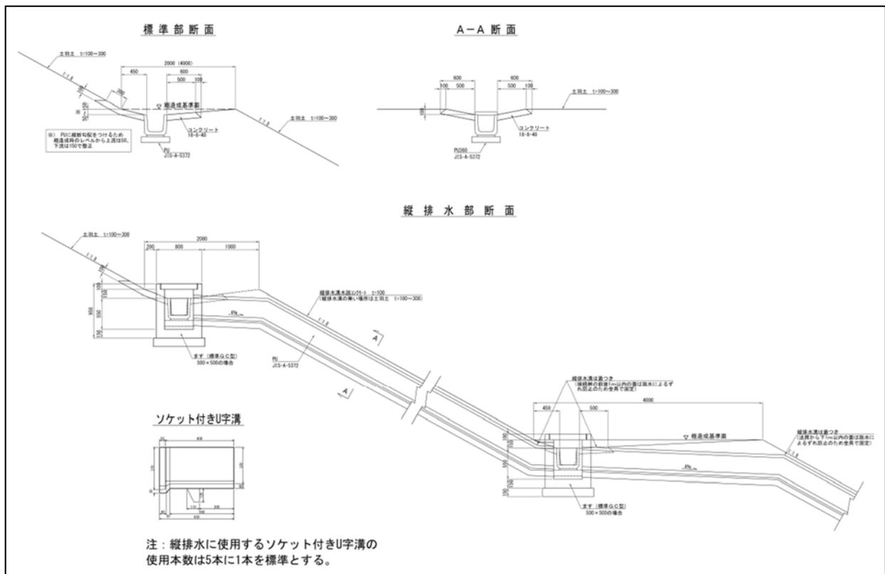
図 6-14 小段排水、縦排水詳細図
