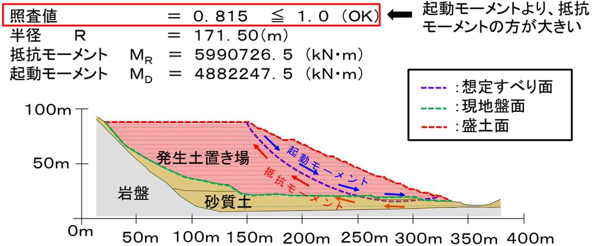
図 6-12 盛土円弧すべり安定検討（地震時水平力考慮状態）
