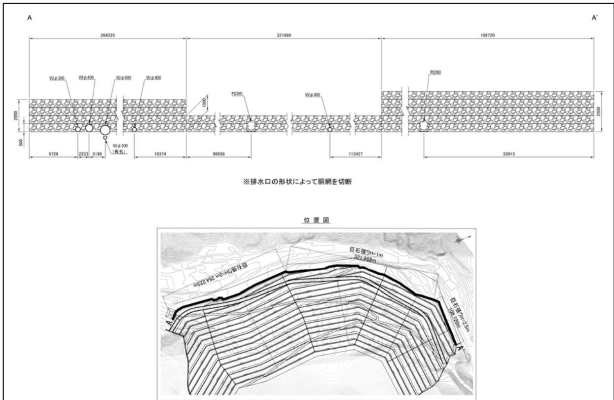
図 6-10 盛土のり尻巨石積み計画平面図
