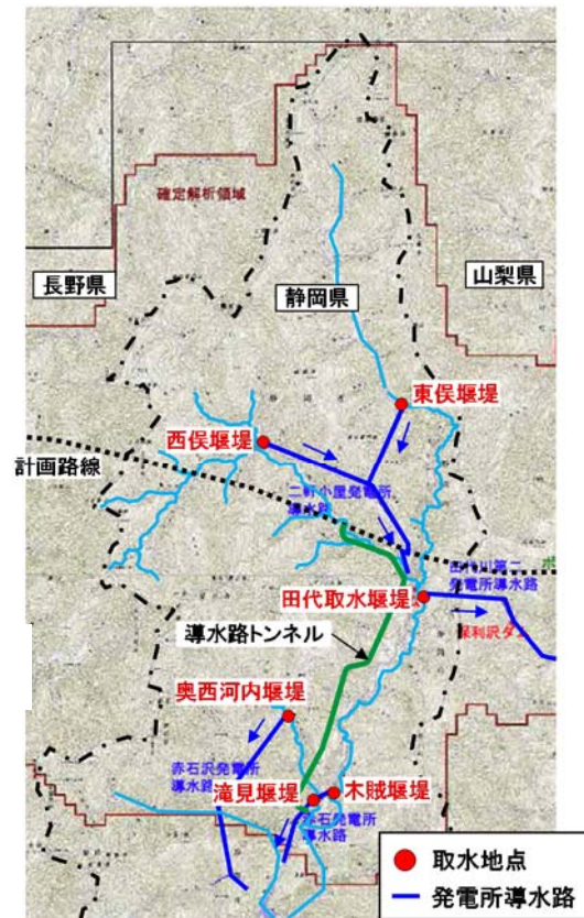
図 5-20 既設導水路トンネル・取水地点
