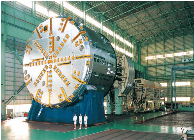
写真 2 飛驒トンネル本坑 TBM (φ 12.84m)
