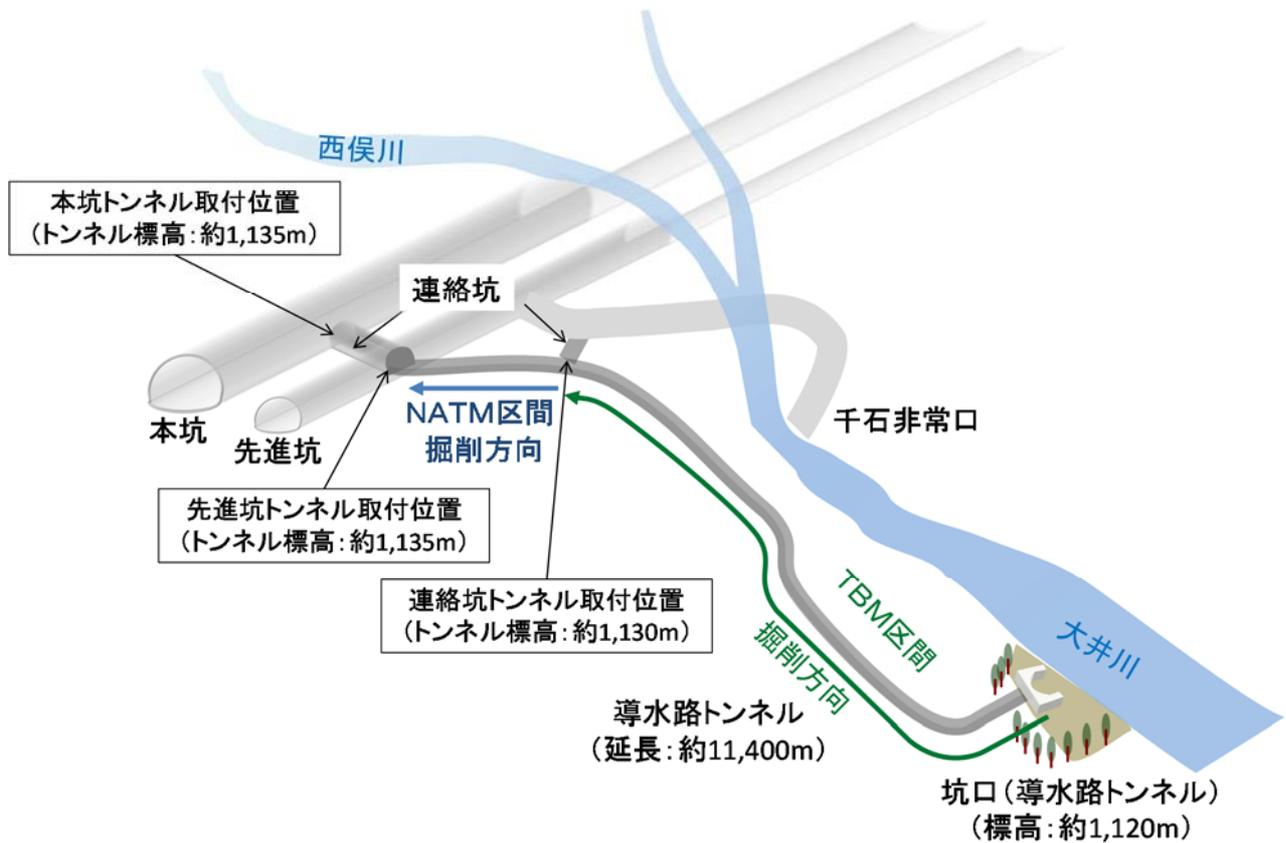
図 導水路トンネル 概念図
