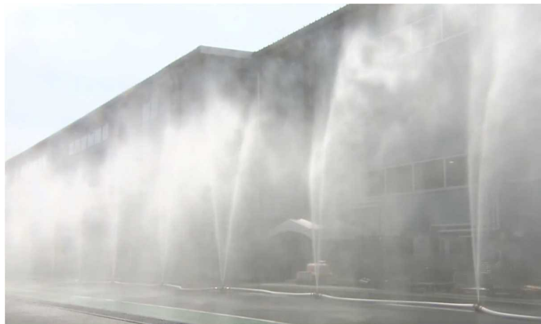
水膜の生成による延焼遅延効果
