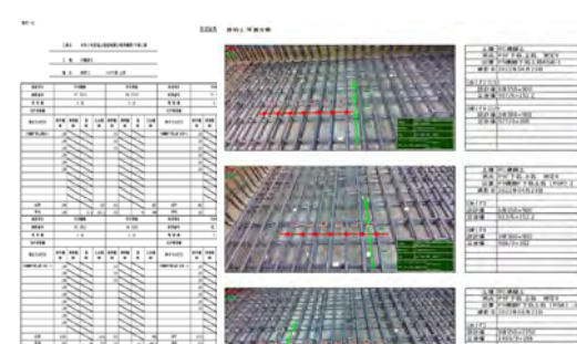
デジタルデータを活用した鉄筋出来形計測
