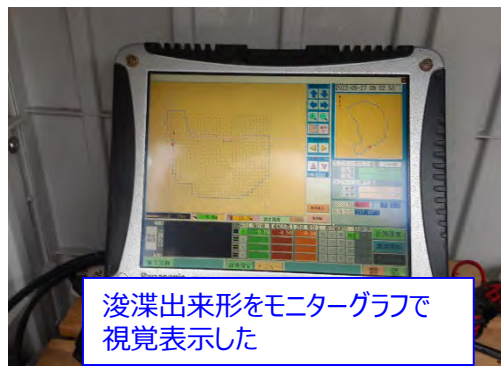
【浚渫出来形のモニター表示】
