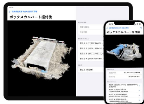
ボックスカルバート計測データ
