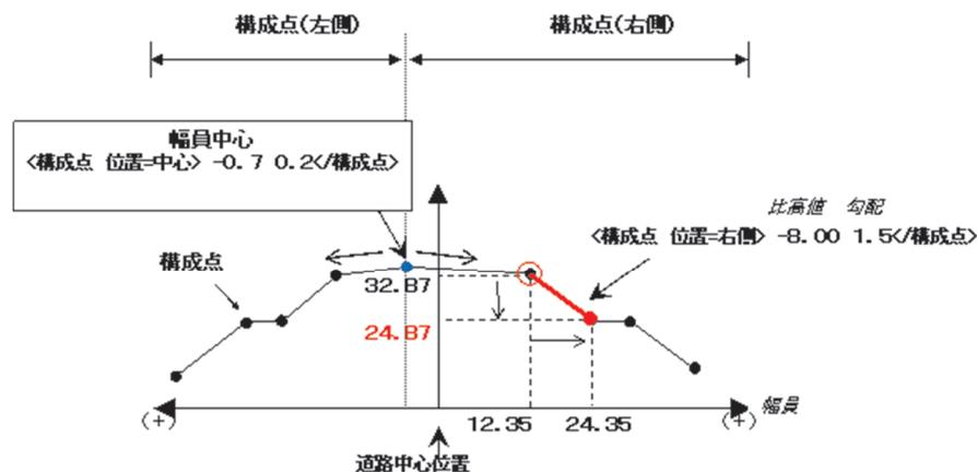
図 出来形横断面形状の一例（道路土工の場合）
