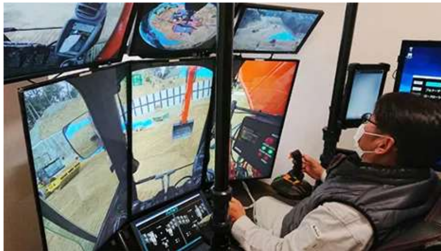
5Gを活用して3種類の建設機械を遠隔操縦する 実証実験を開始(日立建機日本株式会社HPより)
