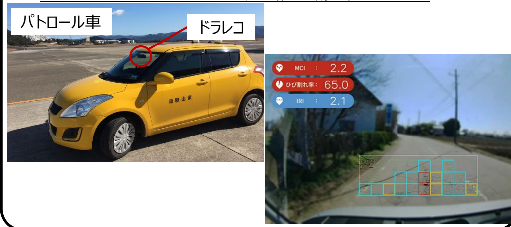
ドライブレコーダーの映像から、道路の損傷を確認する技術
