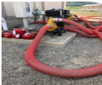
下水管が破損した場合に使用する 地震対策備蓄ポンプ(宮崎市)
